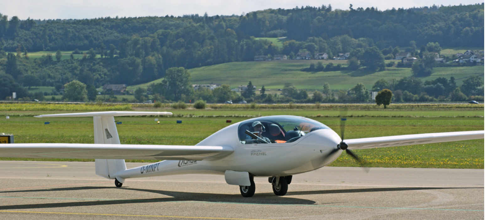
Toni Roth in seiner umgebauten Pipistrel Taurus. Der Raum, der ursprünglich für das Klapptriebwerk hinter dem Cockpit verwendet wurde, dient jetzt zur Aufnahme des Batterie-Satzes. Neu ist dafür der von ihm entwickelte FES-Antrieb im Bug mit einem Geiger-Elektromotor
