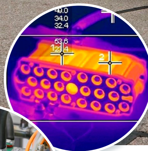
Hightech im Segler: Thermogramm eines Batterietests (o.); der Einscheiben-Wankel samt wassergekühltem Generator des Range Extender (l.).
