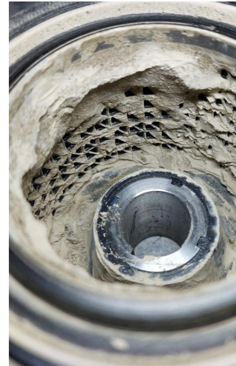
Nach dem Test, zu feuchtes Sichtgut haftet an.
